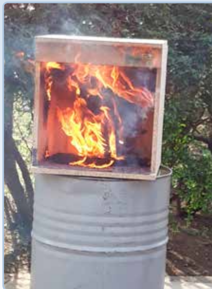
Bild: Flashoverbox zur Simulation eines Zimmerbrandes
